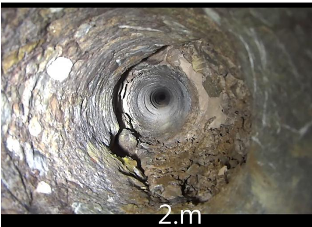
Bohrlochkamera-Aufnahme einer spitzwinklig zum Bohrloch verlaufenden, teilweise versinterten Kluffläche in der Nagel- fluh.
