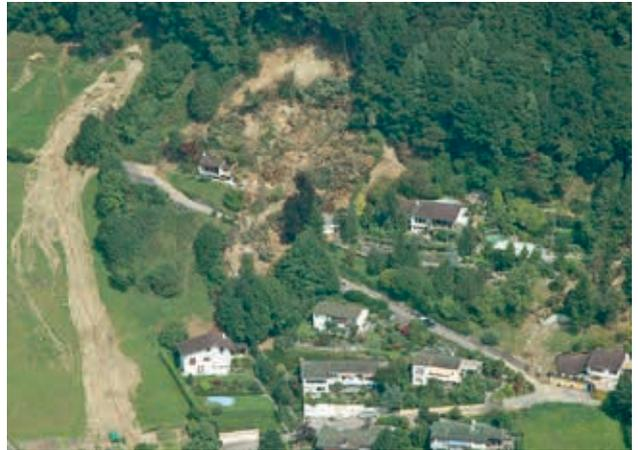
**Abb. 18** Spontanrutsch (30 000 m<sup>3</sup>) im Gebiet Tannenberglisrubi, dem ehemaligen Ausbruchbereich des Schuttstromes 1795
