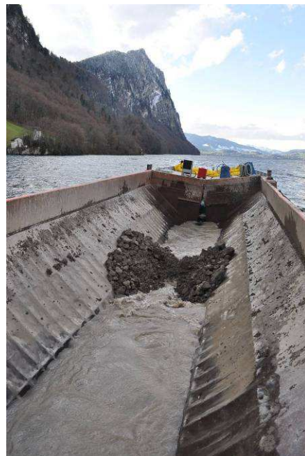
Das Schiff lokalisiert den Ort für die Verklappung präzise mit GPS.
