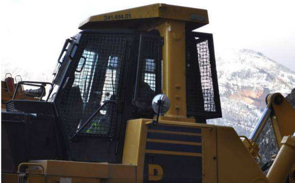
Die Kabinen der Maschinen sind durch ein starkes Stahlgittergewebe gegen Steinschlag geschützt.
